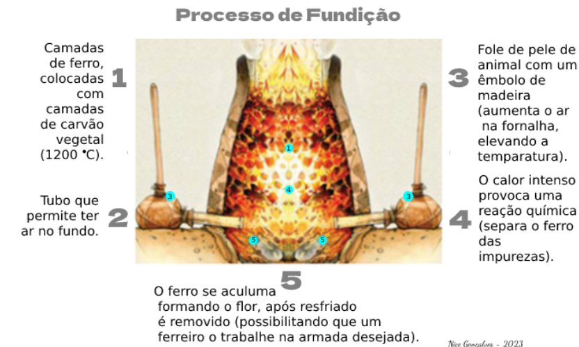
Figura 28. Estrutura do forno de fundição do ferro nas sociedades africanas. Fonte: Eunice Queiroz produções.
