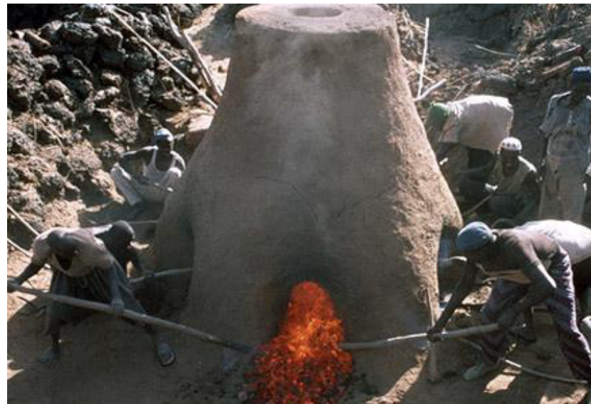
Figura 31. Fotografia de um forno africano atual feito de argila. Fonte: UNESCO. Relatório sobre desenvolvimento da tecnologia do ferro na África.
