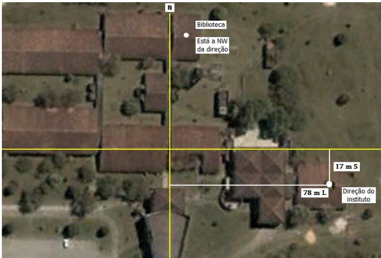
Figura 02. Coordenadas geográficas de um ponto e localização do mesmo em relação a um outro objeto utilizando o sistema métrico.
